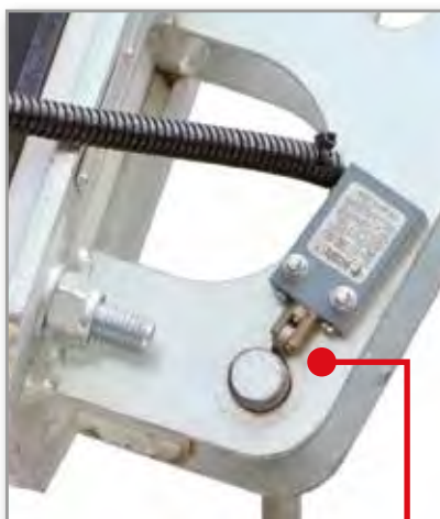
Micro di sicurezza Safety microswitch
